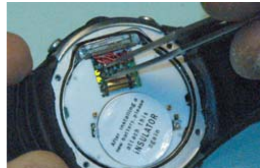
12. Nullázza le a memóriát (master reset) úgy hogy az elektronikus modult zárja rövidre a két elektronikus érintkezőnél, ahogy az a képen látható.
